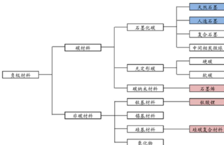
天然石墨负极材料技术有了较大的进步，其可逆容量已达 360mAh/g 以上，并在消费型锂离子电池中获得了广泛的应用。预计在未来的小型电池中，高容量电池仍将以天然石墨为主。人造石墨负极材料当前的应用非常广泛，其优点是长寿命，较低的极片反弹，而缺点是容量相对较低。目前在人造石墨方面的技术改进使得人造石墨也可以发挥 350mAh/g 的可逆
