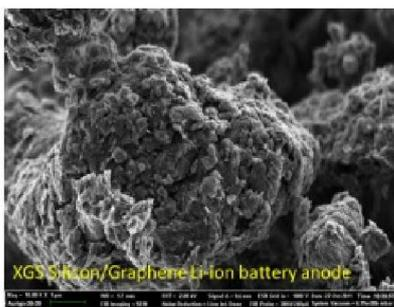
美国 XG Sciences 公司目前生产的 AN-S-100 石墨烯硅负极材料容量可以做到 600 - 2000 mAh/g，首次循环效率可以达到：85-90%。
