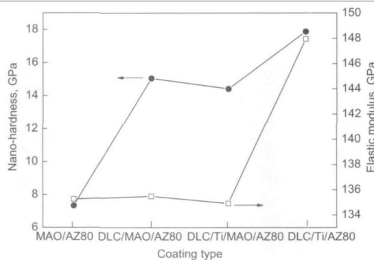
图 2 不同膜基系统的硬度与弹性模量平均值
