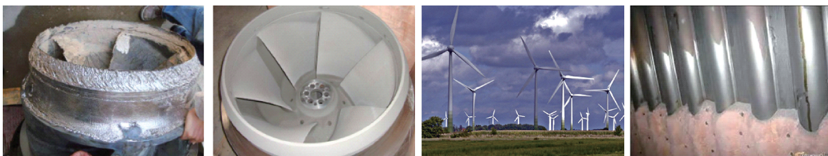
图8 热喷涂非晶涂层在电力材料防护方面的典型应用 [66]
